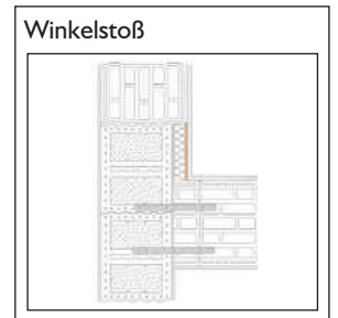
Ist die Außenwand abgewinkelt, dann ist die Durchbindung über die Außenwand hinaus mit Zusatzdämmung die für den Schallschutz beste Variante.
