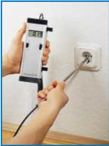
Die Zugluft in Steckdosen kann mit Hilfe eines Thermoanemometers gemessen werden.
