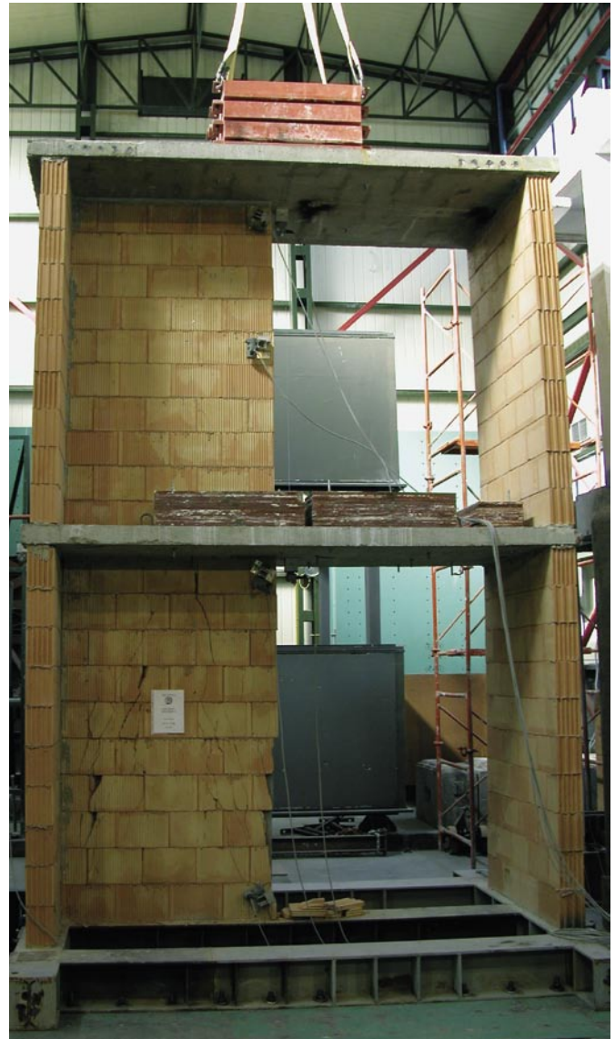
Bild 6: Prüfkörper mit Schubwänden aus Hochlochziegeln und Füllziegeln
