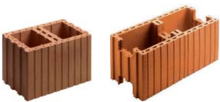
Schallschutz-Füllziegel (links) und Schalungsziegel (rechts) zum Verfüllen mit fließfähigem Beton C12/15 (0-16, F4/5) für Wohnungstrennwände mit Wanddicken 17,5/24/30 cm, R_w \approx 62 dB (24/30 cm)
